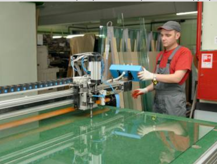
Резка стекла для фасадов-витрин
