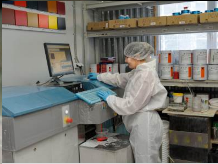
Наведение эмалей колеровочной машиной
