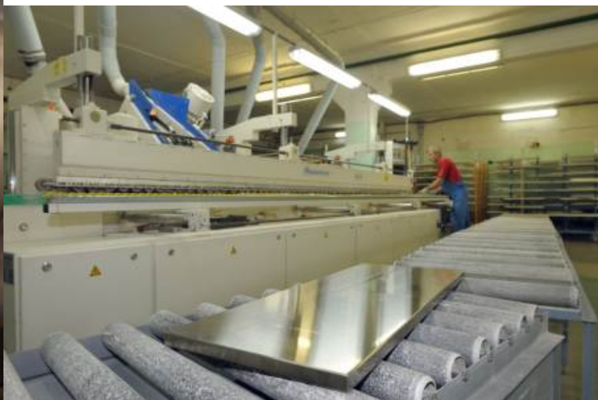
Шлифование фаски у фасада
