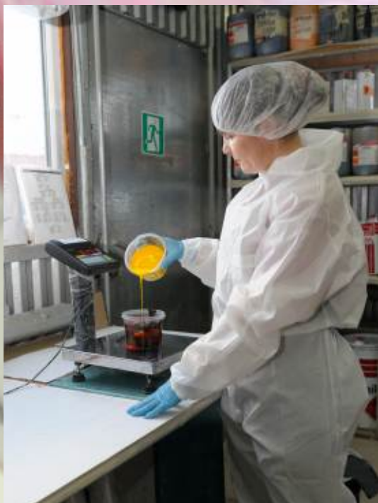
Наведение эмалей при помощи электронных весов
