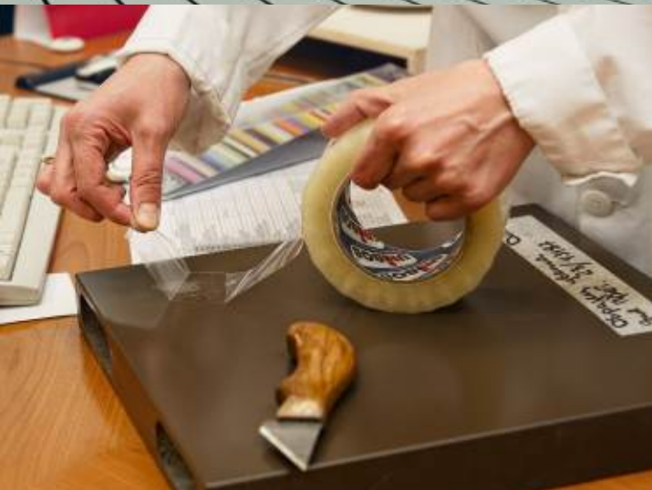
Проверка адгезии лакокрасочного покрытия
