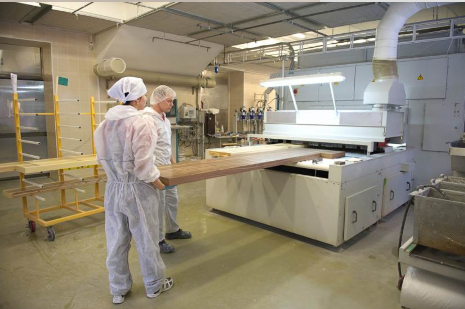
Загрузка деталей в покрасочный комплекс
